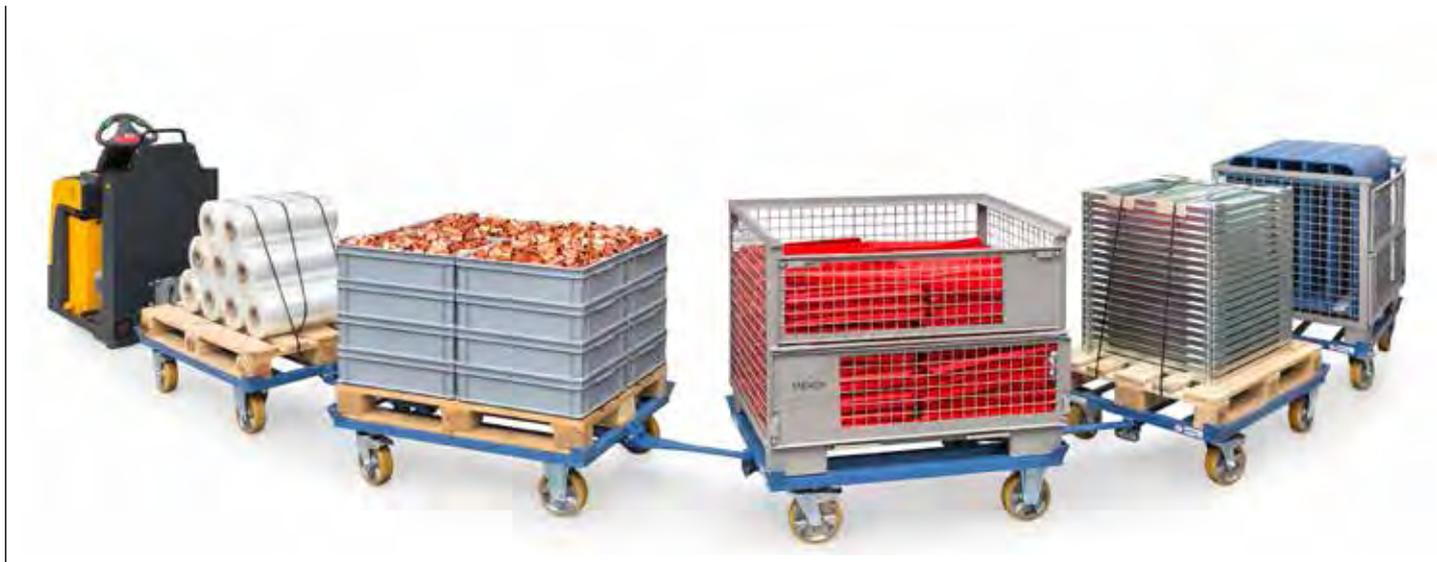
Routenzug mit Elektroschlepper und 5 Paletten-Fahrgestellen
