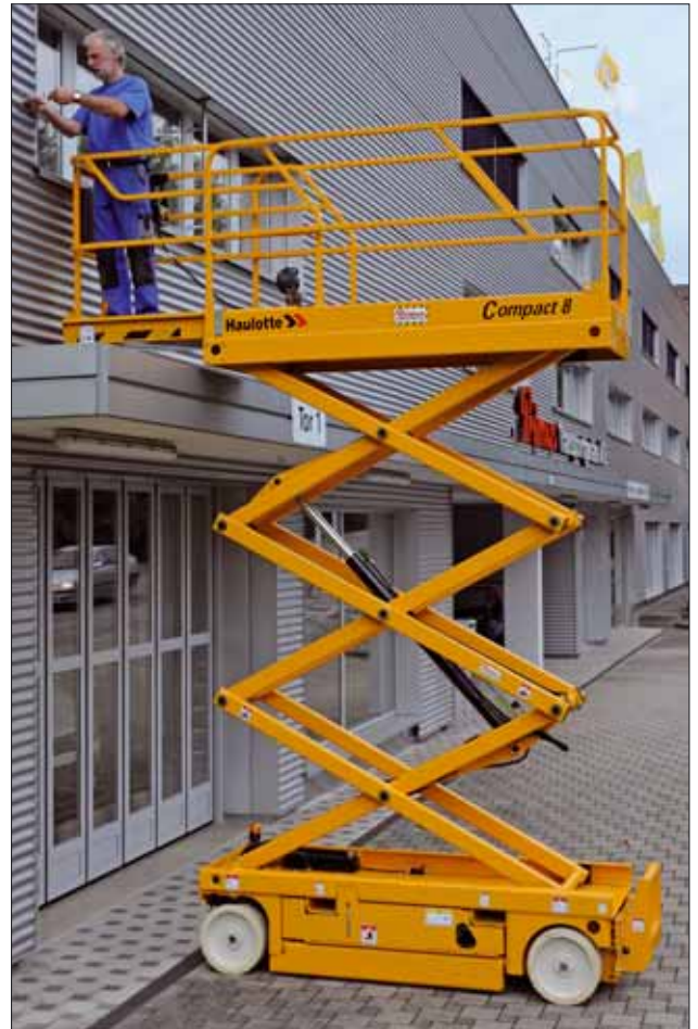
Die Plattform Innenmasse, kann von 2.23 m um 92 cm, auf 3.18 m ausgefahren werden, das ist eine enorm grosse Arbeitslänge!
