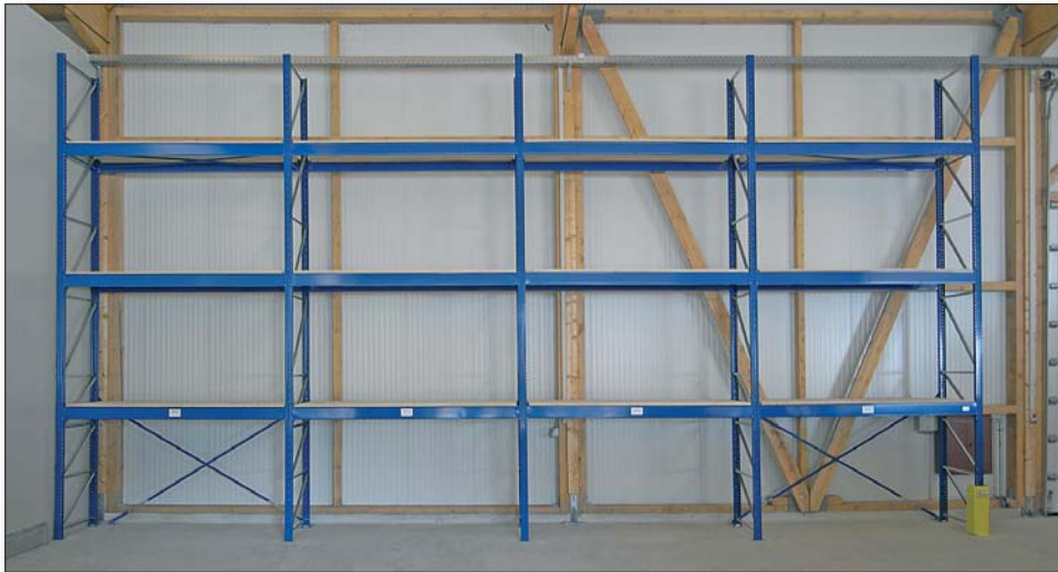
Schwerlastregal, Rahmen CKA 6948 x 1000 mm, Träger C3018, Tragkraft 4500 kg / Paar
