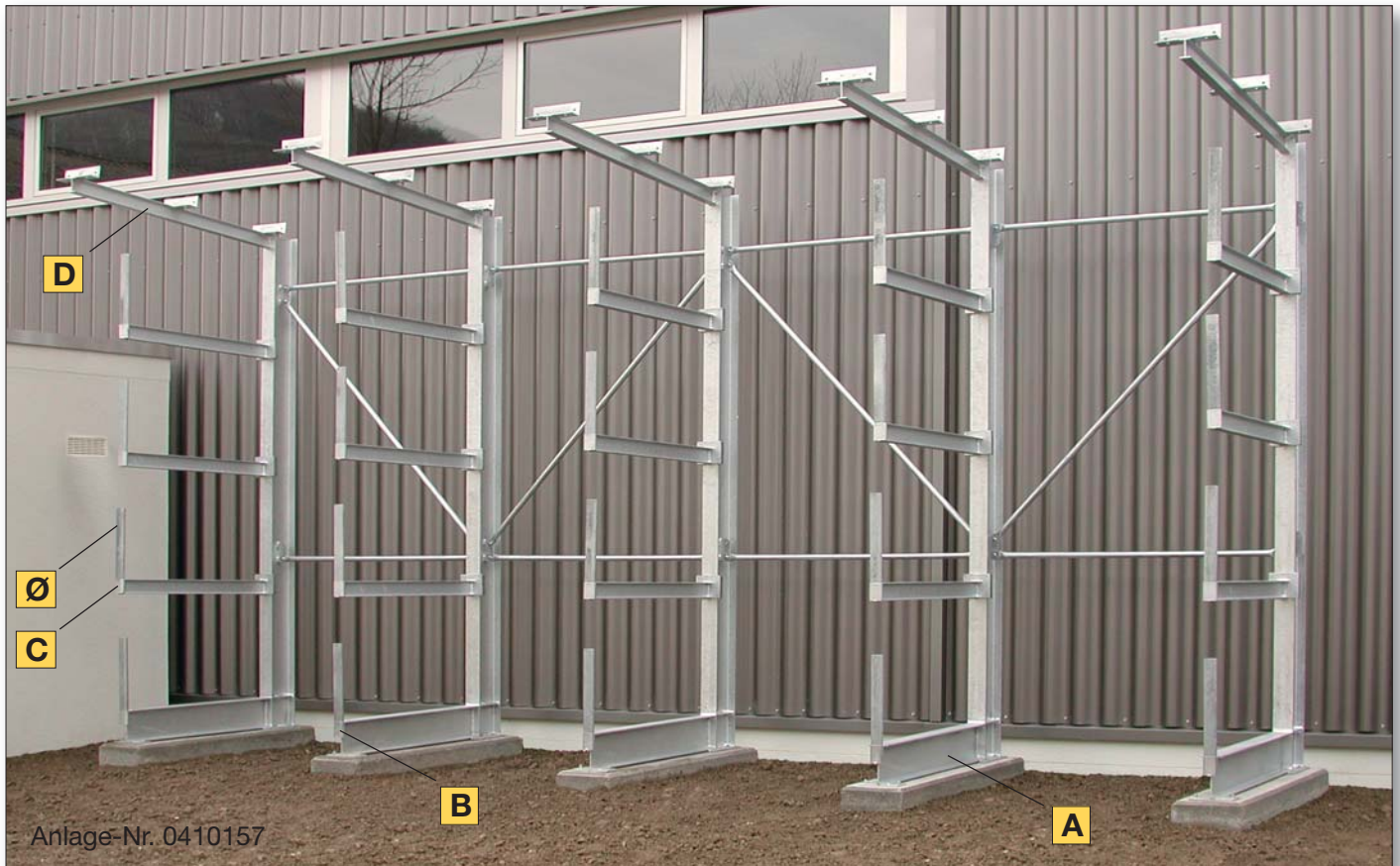
Bild oben: Tragsäule SF18-301003000M, mit Dachträger siehe Zeichnung D, Säule zu Mitte Säule 1500 mm, mit Träger Typ T8-100 à 600 kg Tragkraft, mit Abrollsicherung aus Ovalrohr Höhe 400 mm, alles feuerverzinkt. Streifenfundament bauseits.
