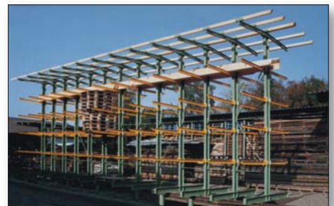
Bild oben: Tragsäule SF18-301003000M, mit Dachträger siehe Zeichnung D, Säule zu Mitte Säule 1500 mm, mit Träger Typ T8-100 à 600 kg Tragkraft, mit Abrollsicherung aus Ovalrohr Höhe 400 mm, alles feuerverzinkt. Streifenfundament bauseits.
