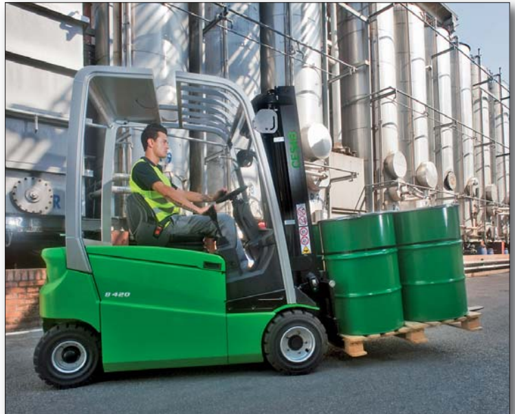
B420 mit Duplex-Freisichtmast 3170 mm
