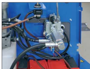
Ansicht Dosierventil = externes Ladegerät!
