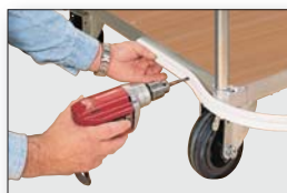
Kantenschutz PVC Profil wird aufgenietet
