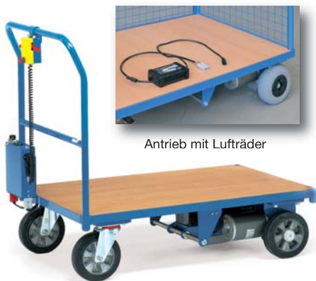
Anbausatz Elektroantrieb Modell 2200 ab Radgröße 200 mm + Wagenbreite 500 mm
