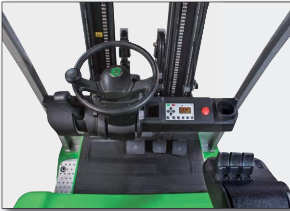
Hervorragende Sicht mit Vollfreihubzylinder
