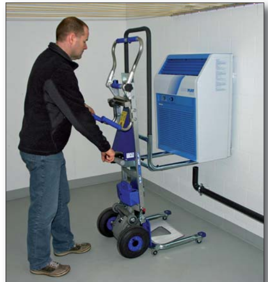
Plattform kann demontiert werden mit 2 Schrauben
