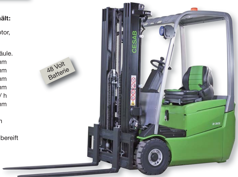
B315 mit Duplex-Freisichtmast 3170 mm
