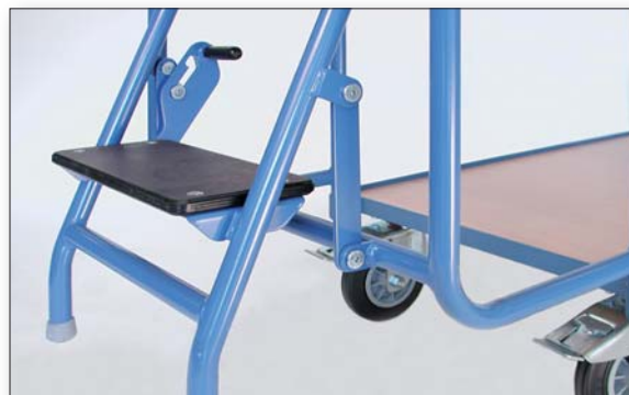
Leiter angeklappt, in Ruhestellung, Verschluss nicht eingerastet!
