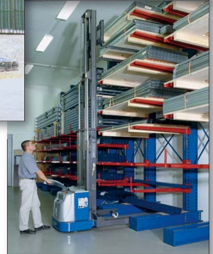
4 VIE SL 155/45 Spezial Triplexmast Höhe 4500 mm mit Flachstahl-Gabeln
