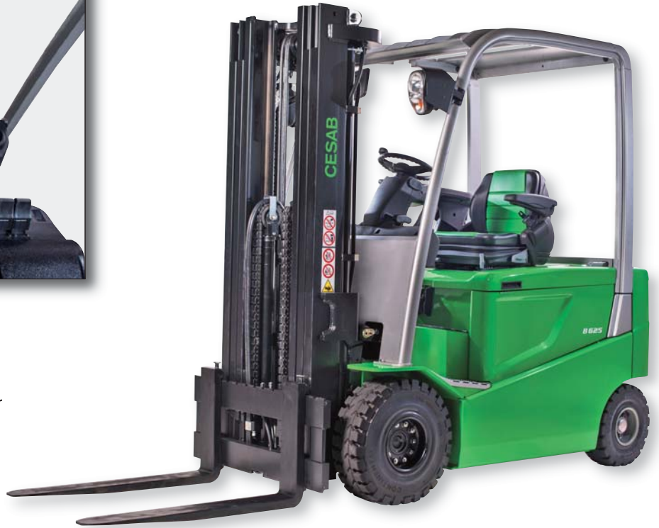
B625 mit Triplex-Freihubmast 4700 mm, H1=2205 mm bei 2500 kg Modell
