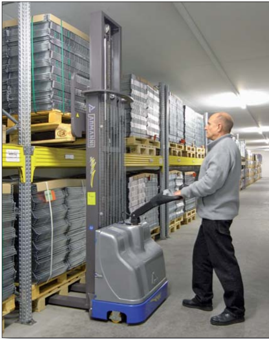
Master 105/29 im Einsatz, Raumhöhe 2.97 m, max. Hub bis oberkannt Gabel 2.07 m.
