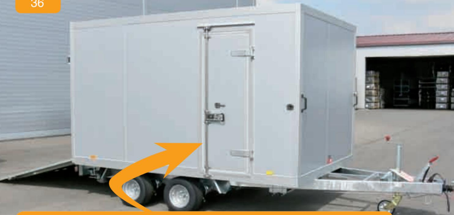
**Seitentür mit Drehstangenverschluss**
