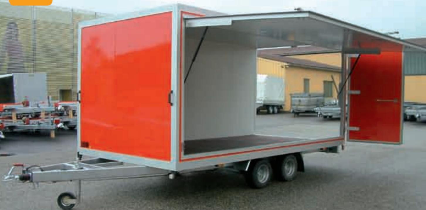
**Abgeklapptes Heck mit Stützen**
